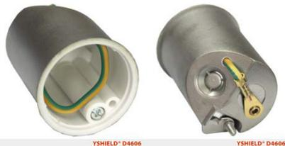
Geschirmt mit Metall-Vakuum-Beschichtung. Potentialanschlussleitung 1,5 mm<sup>2</sup> starr. Als Wandleuchten-Auslassdose. Durchmesser 35 mm, Tiefe 45 mm. Norm-Montageabstände.
