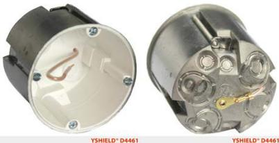
Geschirmt mit Metall-Vakuum-Beschichtung. Potentialanschlussleitung 1,5 mm<sup>2</sup> starr. Als Abzweig- und Schalterdose verwendbar für Plattenstärken von 7-35 mm. Norm-Montageabstände.
