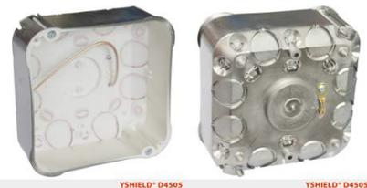
Geschirmt mit Metall-Vakuum-Beschichtung. Potentialanschlussleitung 1,5 mm<sup>2</sup> starr. Als Verbindungskasten für Putz und Hohlwand. 107 x 107 x 53 mm. Norm-Montageabstände.
