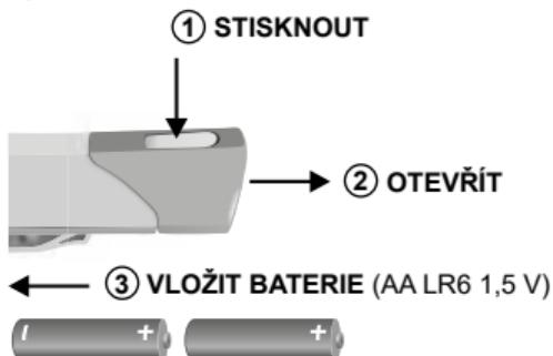
Chcete-li baterii vyměnit, musíte otevřít kryt baterie a po vložení baterie ho opět zavřít (viz obrázek).
