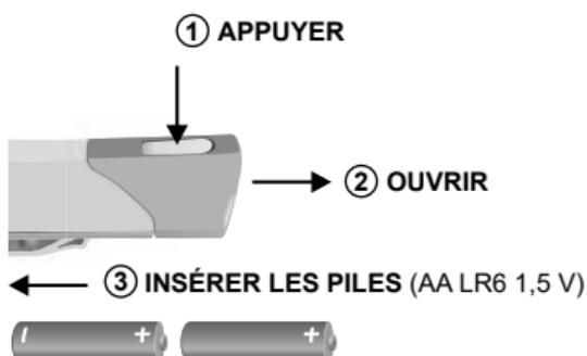
Pour changer les piles, ouvrez le cache et remettez-le en place après avoir inséré des piles neuves (voir l'illustration).
