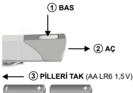
Pil değiştirme için pil kapağı çıkarılmalı ve piller yerleştirildikten sonra tekrar takılmalıdır (bakınız Resim).
