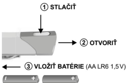
Pri výmene batérií sa musí otvoriť kryt na batérie a po vložení batérií sa musí kryt opäť nasadiť (pozri obrázok).
