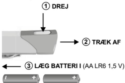
Til udskiftning af batteriet skal batterihætten åbnes, og sættes på igen, når batteriet er lagt i (se illustrationen).
