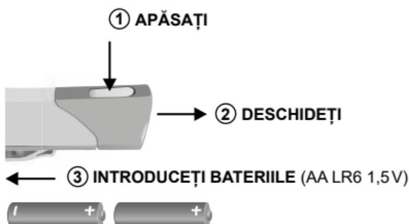
Pentru schimbarea bateriilor trebuie deschis capacul carcasei pentru baterii și închis la loc după introducerea noilor baterii (consultați figura).
