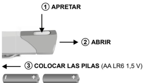
Para cambiar las pilas quitar la tapa de las pilas y, después de cambiarlas por otras nuevas, poner la tapa otra vez (ver la imagen).
