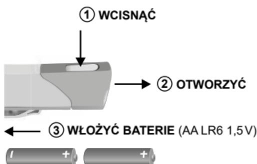
W celu wymiany baterii należy zdjąć osłonę komory baterii, a po włożeniu baterii należy ją z powrotem nałożyć (patrz ilustracja).
