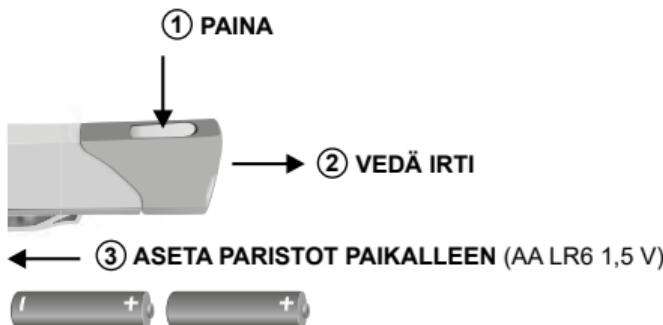
Pariston vaihtoa varten paristolokeron suojuus on avattava ja jälleen suljettava paristojen vaihtamisen jälkeen (katso kuva).
