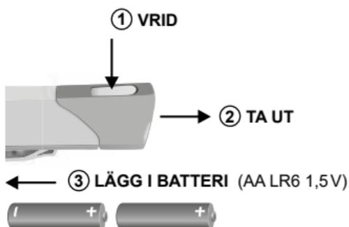
Vid batteribyte måste batterilocket öppnas och sättas tillbaka efter inläggning av batteriet (se bild).
