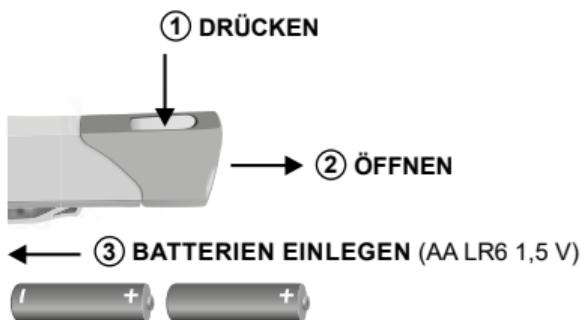
Zum Batteriewechsel muss die Batteriekappe geöffnet und nach dem Einlegen der Batterien wieder aufgesetzt werden (siehe Abbildung).
