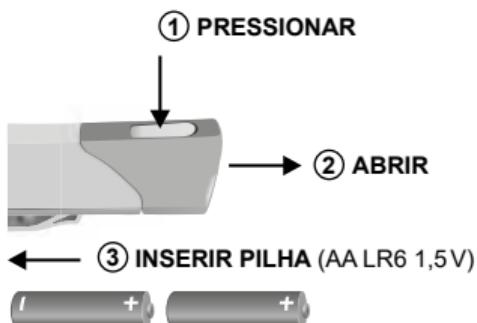
Para trocar as pilhas, a tampa das pilhas tem de ser aberta e, depois de trocar as pilhas, tem de voltar a ser colocada (v. figura).
