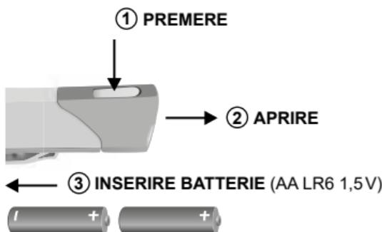
Per sostituire le batterie aprire la calotta del vano batterie e richiuderla una volta inserite le batterie nuove (v. figura).
