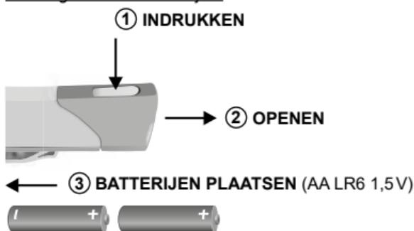
Voor het vervangen van de batterijen moet het batterijdeksel worden geopend en na plaatsing van de batterijen weer worden aangebracht (zie afbeelding).
